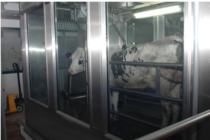
Fig. 2 – Camera respiratoria a circuito aperto per la determinazione del metano prodotto. Centro zootecnico di Cascina Baciocca, Cornaredo (MI), dell'Università degli Studi di Milano.
